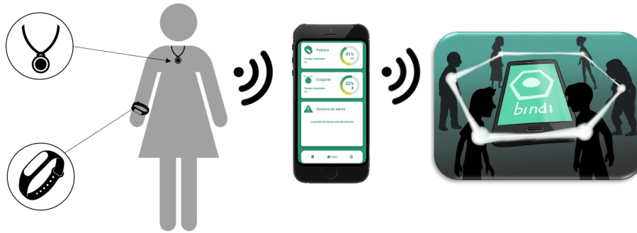
Figure 5-1: Arquitectura simplificada del sistema Bindi basado en las diferentes tecnologías del IoT.
