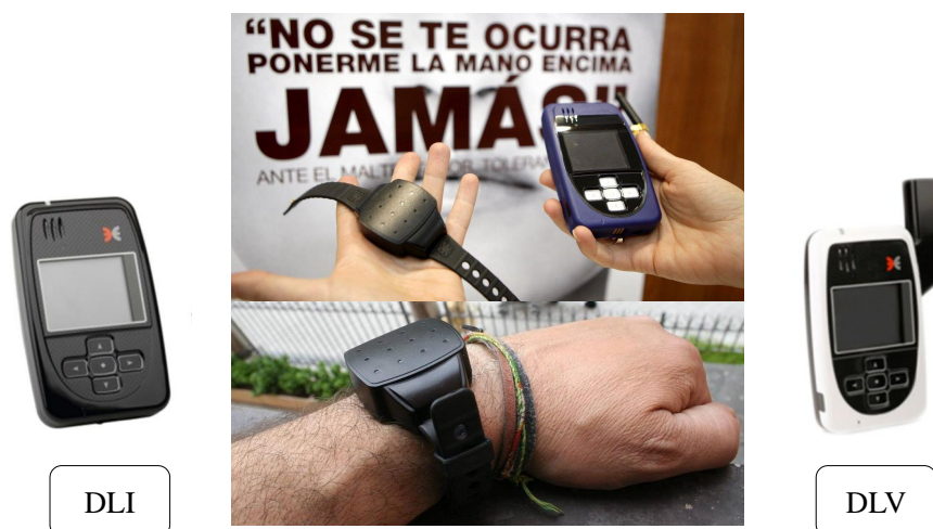
Figure 5-2: Dispositivos considerados para el sistema de vigilancia electrónica dentro del "Protocolo de actuación del sistema de vigilancia por medios telemáticos de las medidas y penas de alejamiento en materia de violencia de género". DLI: Dispositivo que lleva el agresor; DLV: Dispositivo que lleva la víctima [9].
