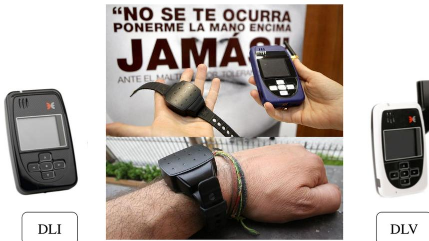
Figure 5-2: Dispositivos considerados para el sistema de vigilancia electrónica dentro del "Protocolo de actuación del sistema de vigilancia por medios telemáticos de las medidas y penas de alejamiento en materia de violencia de género". DLI: Dispositivo que lleva el agresor; DLV: Dispositivo que lleva la víctima [9].
